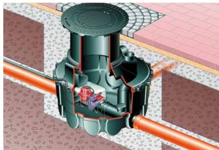
Rückstausicherung außerhalb des Gebäudes
